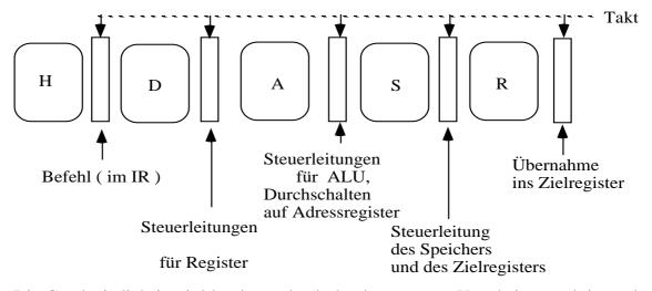
Die Geschwindigkeit wird bestimmt durch den langsamsten Verarbeitungsschritt; er bestimmt die Taktrate, mit der die Zwischenergebnisse in die Latches der Pipeline übernommen werden (Geleitzugprinzip: der langsamste Schiff bestimmt die Geschwindigkeit).
