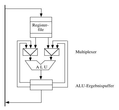
Als Beispiel für einen Rechner mit Bypasseinheit möge die DLX-Maschine dienen:
